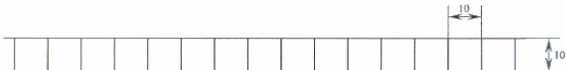
Rys. 1 Budowa komorowa badanej płyty
